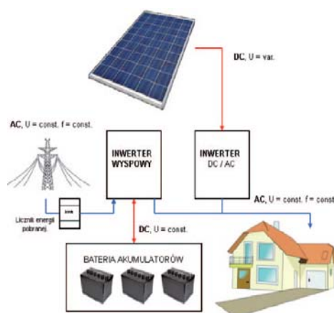
Rysunek 28 Schemat instalacji mieszanej 186 (oznaczenia: DC- prąd stały, AC-prąd przemienny, U- napięcie, f-częstotliwość, var.-zmiennie, const.- stałe)
